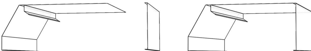
3) Закрепить боковины с передней стенкой, крышей и задней стенкой при помощи болтов М5.
