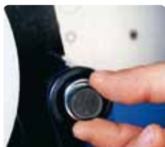
Tensión de film regulable. Adjustable stretchfilm tension. Tension film réglable.
