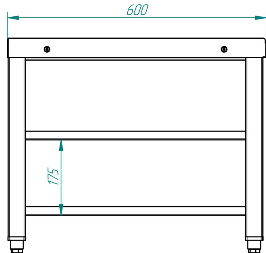
Подставка предназначена для установки фронтальной посудомоечной машины на столешницу и размещения корзин для мытья посуды на полках.
