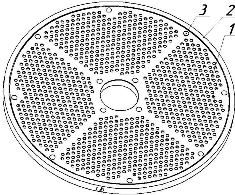
**Рисунок 16 – Диск протирочный**
