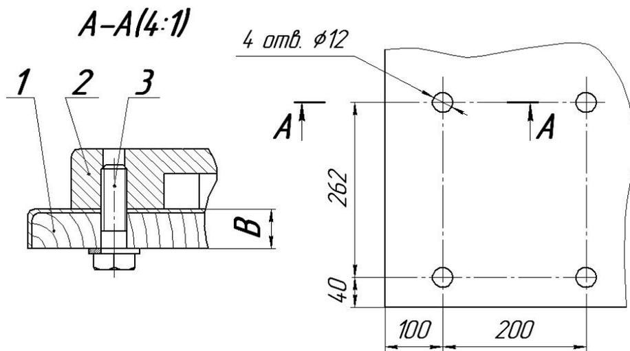
Рисунок 26 – Схема установки приводного механизма на столе
