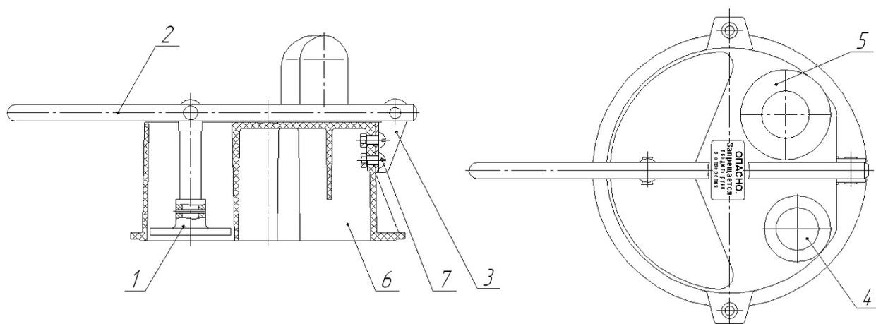
**Рисунок 11 – Приспособление загрузочное овощерезательное**
