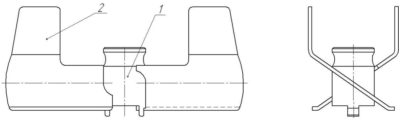
**Рисунок 15 – Ротор лопастной**
