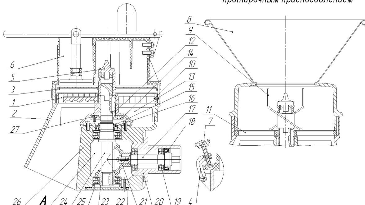
**Рисунок 10 – Механизм овощерезательно - протирочный МО**
