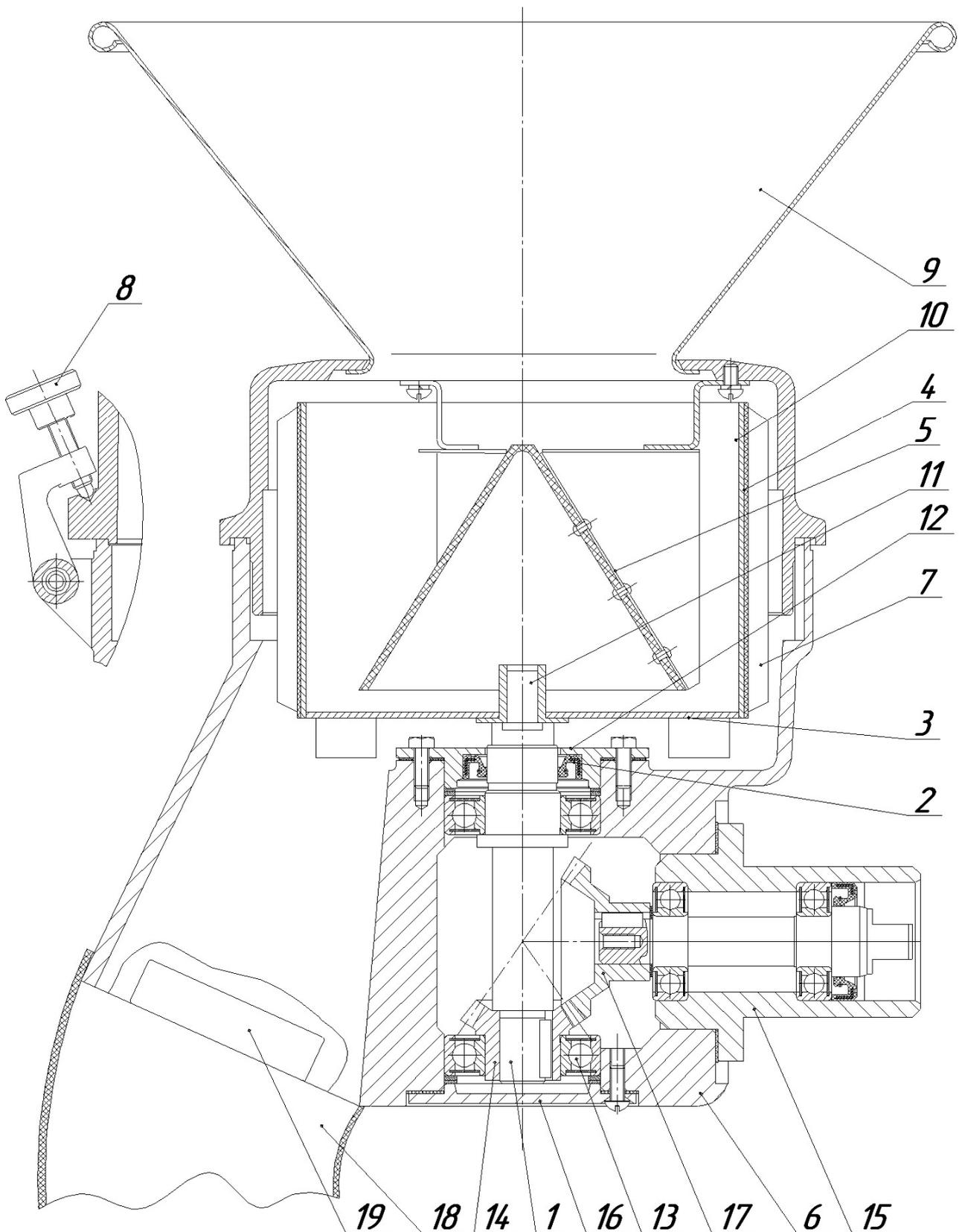
**Рисунок 19 – Просеиватель МП – 01**
