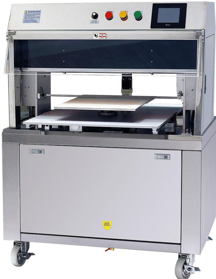
Данная автоматическая резательная машина значительно ускоряет производственный процесс нарезки различных тортов и бисквита. Применяется в кондитерских, пекарнях, на хлебозаводах и предприятиях общественного питания.
