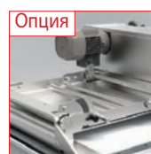
Модуль для предварительного вытягивания тестозаготовок
